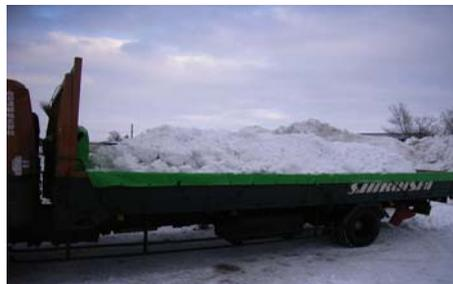
排雪シートとは、運搬車両に除雪した雪を積んで排雪場での作業の軽減化を目的とした排雪用トラックシートです。現状の排雪場作業では、主に手作業による排雪作業が行われていますが、排雪シートをトラックの荷台に敷設する事で、今までよりも効率良く排雪でき、迅速かつコスト低減効果も期待出来ます。また、排雪シートは冬季間の養生シートまたはトラックシートや多目的シートとしても、ご利用頂ける事が出来ます。
